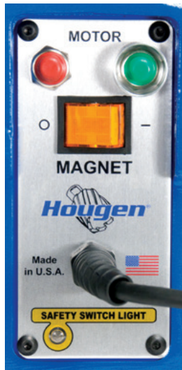
PLACA DE INTERRUPTORES DEL PANEL DE CONTROL
