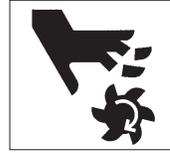
**¡CUIDADO!** Los cortadores anulares son filosos. Utilice guantes al instalar o sacar el cortador anular del árbol. No agarre un cortador anular en movimiento.
