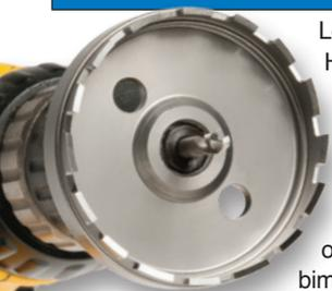
Los cortadores Anulares Holcutter de acero de alta velocidad duran **10 veces más** y cortan **3 veces más rápido** que las brocas helicoidales o las sierras de copa bimetalicas. Todos los cortadores Anulares emplean un solo árbol, con el sistema patentado de acople roscado Quad-Lead. Pueden utilizarse con materiales de hasta 3,2 mm (1/8") de grosor.
