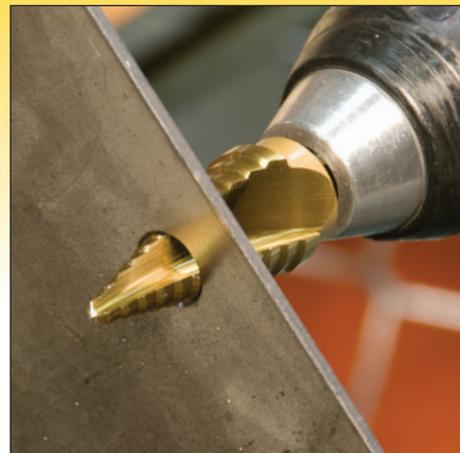
Las brocas escalonadas Hougen® permiten perforar orificios de diversos tamaños con una sola broca. Estas herramientas poseen una vida útil más prolongada, porque están fabricadas en acero de alta velocidad M42 Premium (cobalto) y recubiertas de nitruro de titanio. La punta hendida comienza a perforar rápidamente el material y las canaletas de doble ángulo aumentan la velocidad de penetración. Se pueden utilizar con chapa metálica, aluminio, acero inoxidable y algunos plásticos.
