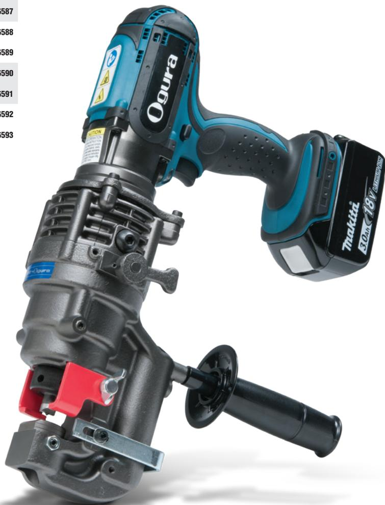
Los datos sobre la capacidad de perforación están basados en el uso de acero leve con una resistencia a la tracción de 65.000 psi.
