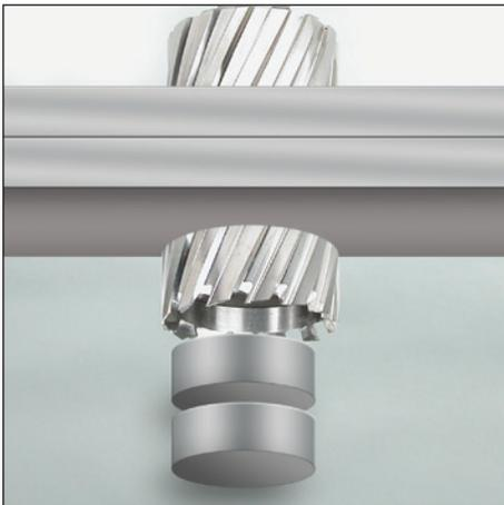
Los cortadores anulares de la "Serie-12,000" de Hougen con geometría "Stack-Cut" deben ser utilizados para perforar dos o más placas al mismo tiempo. Cuando se perforan múltiples placas con un cortador tradicional, después que la primera pieza esta perforada, se debe parar y remover el centro sólido antes de continuar con la segunda pieza. Esto no es problema cuando se utiliza un cortador anular Hougen con geometría "Stack-Cut" puede perforar todas las piezas simultáneamente.
