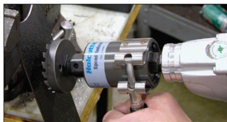
Con una relación de engranajes de 4:1, el reductor de velocidad Holcutter™ se monta directamente en el taladro de 1/2" y mantiene la torsión, mientras reduce la velocidad de los cortadores Anulares Holcutter de acero de alta velocidad de 1" o más grandes. Los cortadores Anulares se instalan en el reductor de velocidad sin necesidad de utilizar un árbol.
