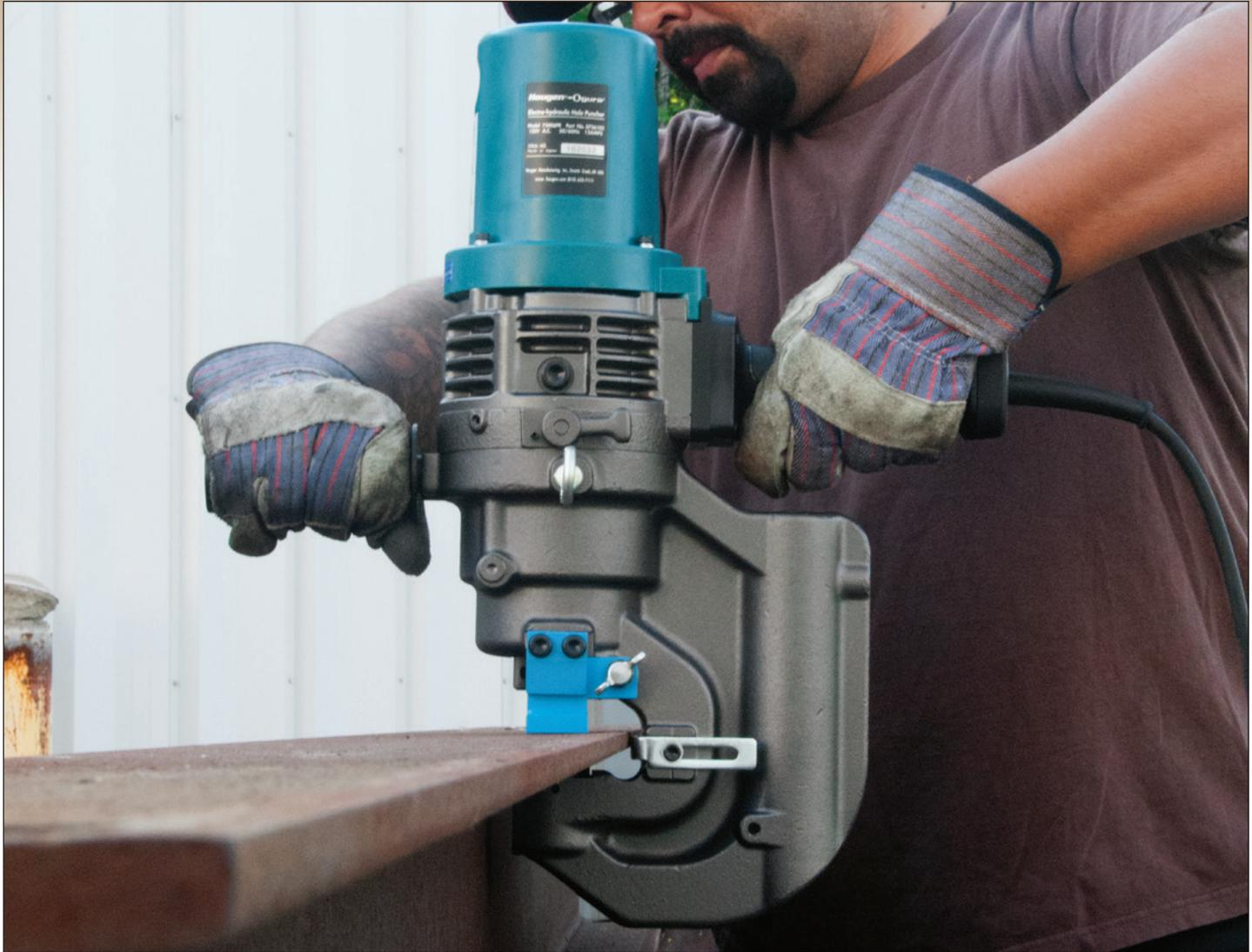
Con la perforadora electrohidráulica Hougen®-Ogura™ Punch-Pro™, usted podrá perforar más orificios, más seguidos, en más sitios y en menos tiempo, gracias a su estructura liviana, fabricada en una sola pieza. A diferencia de las punzonadoras con sistema hidráulico independiente, que requieren el uso de mangueras hidráulicas, la serie Punch-Pro posee un exclusivo diseño de una sola pieza, que solo requiere el uso de un cable de alimentación eléctrica.
