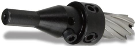
También puede utilizar los cortadores anulares "serie 12,000" con herramientas fijas y taladros de prensa. El vástago con tres caras planas se adapta a mandriles de 1/2". Se emplea con cortadores anulares "serie 12,000" con una profundidad de corte de 25 mm (1") en materiales de hasta 12,7 mm (1/2") de grosor. (No se deben utilizar con cortadores anulares Copperhead).
