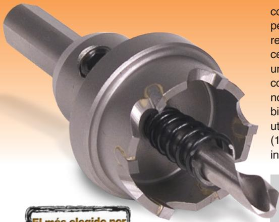
como tope para evitar que la herramienta penetre demasiado en la pieza de trabajo. El resorte de expulsión ayuda a expulsar el bocado central sólido. El carburo de tungsteno garantiza una vida útil prolongada y una operación de corte uniforme. Estos cortadores superan notablemente la vida útil de las sierras de copa bimetalicas y las brocas escalonadas. Pueden utilizarse con materiales de hasta 3,2 mm (1/8") de grosor. (Todos los cortadores Anulares incluyen árbol, centro piloto y resorte).
