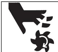
Os cortadores são pontiagudos. Use luvas quando for instalar ou remover o cortador da árvore. Não segure um cortador em rotação.
